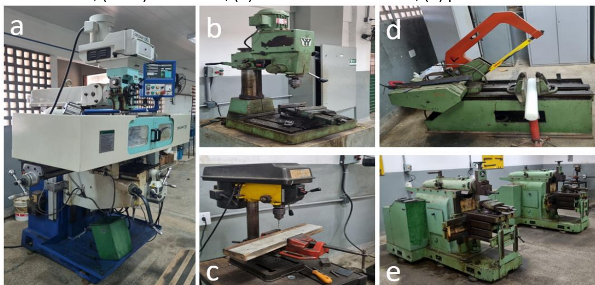
Figura 5: Identificação de riscos mecânicos em equipamentos auxiliares: (a) ferramenteira; (b e c) furadeiras; (d) serra eletro-hidráulica; (e) plainas mecânicas.
