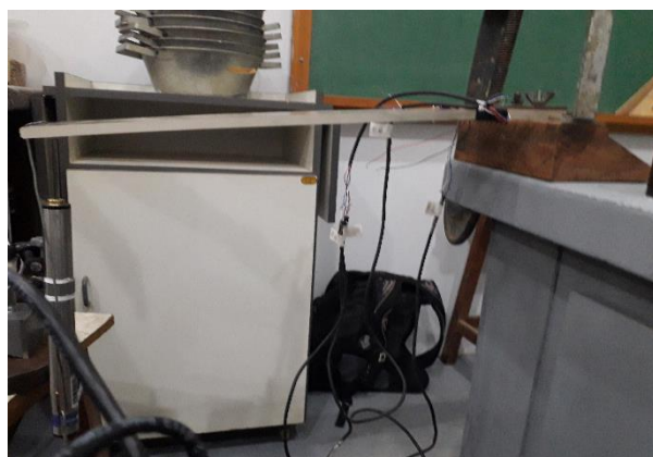
Figura 7 – Placa de acrílico deformada
